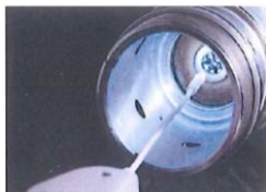
配電盤・分電盤や細い穴の奥などを照らし確認することができます
